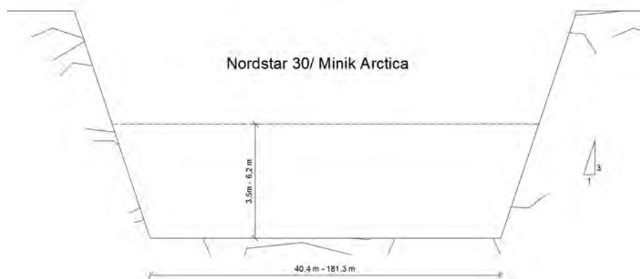
Figur 1: Principtværsnit af kanal med mål angivet for Nordstar 30 samt Minik Arctica.
