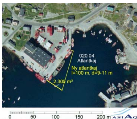
Udbygning af Qaqortoq atlantkaj til 9-11 m vanddybde
