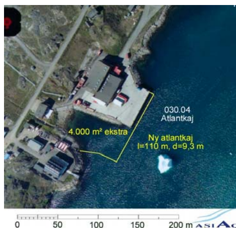
Udbygning af Narsaq Atlantkaj til 9,3 m vanddybde
