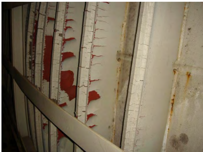
Figur 3 Skader på RAL skib (Arina Arctica) efter sejlads i storis
