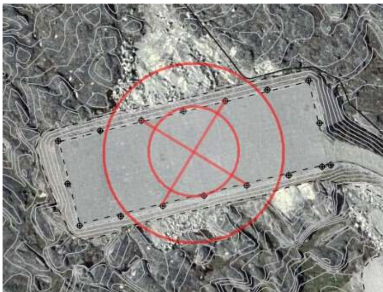
Figur 20: Alluitsup Paa (overgået fra rektangulær 20 x 60m til cirkulær 18m i diameter)
